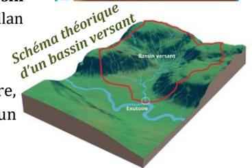
Sous l'effet gravitaire, les rivières s'écoulent sur une aire de drainage et se convergent vers l'exutoire, d'où la notion du bassin versant. Le bassin versant peut-être extrait à partir d'une carte topo ou d'un MNT (Modèle Numérique de Surface).
