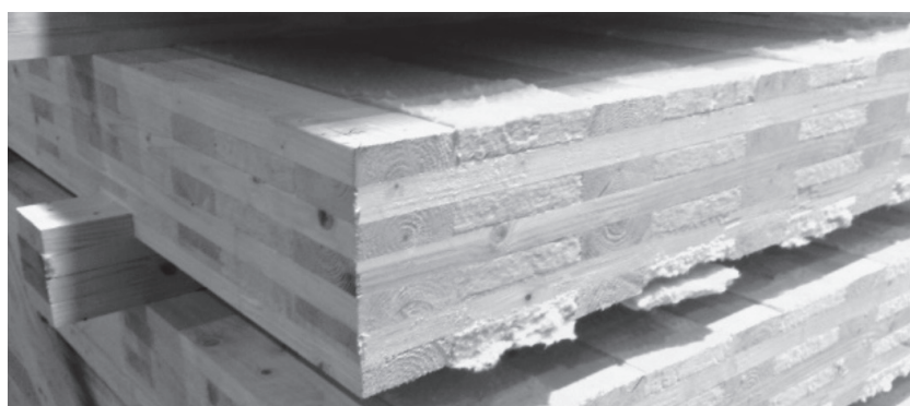
Figure 8. Panneaux CLT creux. Les vides sont remplis par un isolant (Procédé Techniwood).
