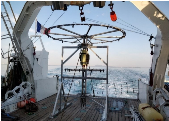
Figure 2. Antenne conique « pointe vers le bas » construite pour la campagne Cavalaire 2018 sur le pont de l'Europe. (Crédits IFREMER).
