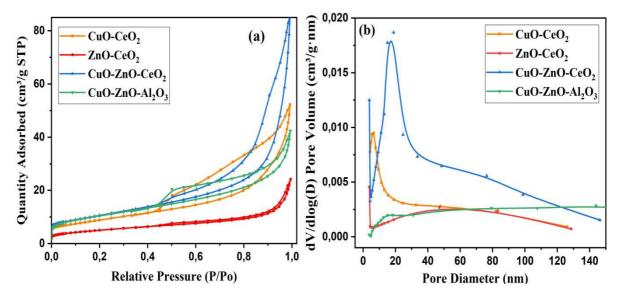
Fig.3. (a)  $N_2$ -adsorption—desorption isotherms and (b) Pore size distribution, of all samples (a) Isothermes d'adsorption et désorption d'azote et (b) distribution poreuse des échantillons
