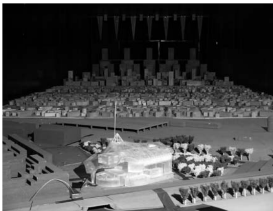
Fig. 10.7. - Rugosités simulant le vent en amont de la maquette d'étude
