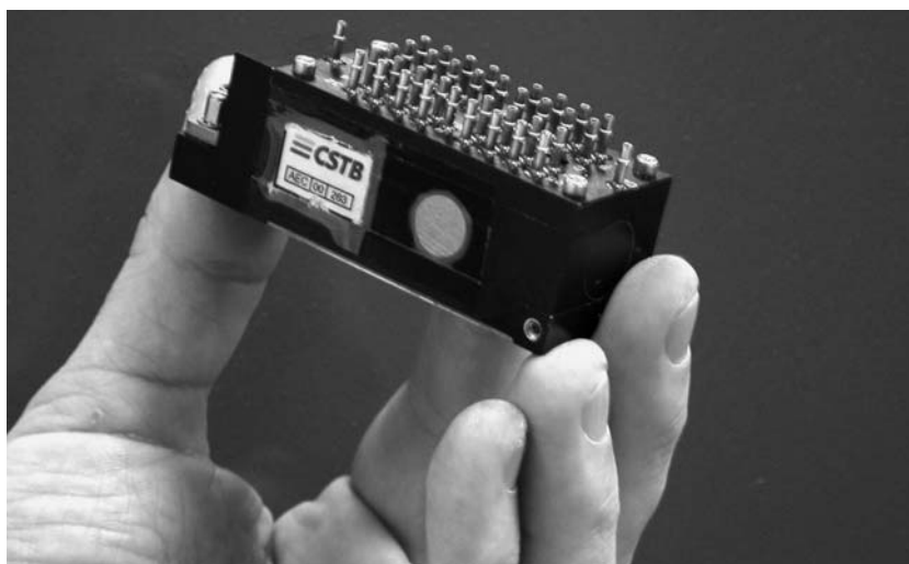
Fig. 11.2. - Module de capteurs de pression multivoies
