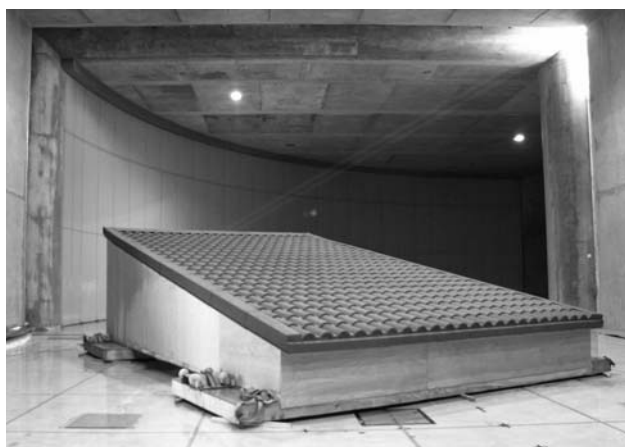
Fig. 11.9. - Tenue au vent d'éléments de couverture
