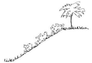
Fig. 8.8. - Stabilisation du talus par végétalisation.
