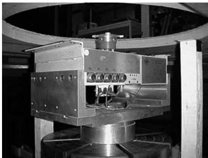
Fig. 11.4. - Balance dynamométrique à 6 composantes
