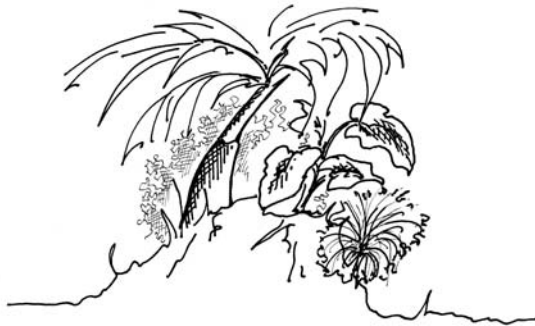
Fig. 4.1. - Intégration et stabilisation d'un talus par plantation.
