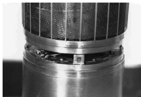
Fig. 11.6. - Balance de pied de la maquette de la Tour sans Fins
