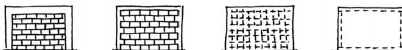
Fig. 7.6. - Murs de contreventement a) Ossature poteaux-poutres avec remplissage en maçonnerie b) Maçonnerie chaînée c) Voile en béton armé d) Mur à ossature bois contreventé par panneaux de contreplaqué ou OSB
