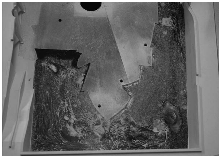
Fig. 11.0. - Visualisation pariétale montrant, en vue de dessus, les recirculations à la surface d'un bassin d'eau. Les filets blancs représentent les trajectoires de l'écoulement à la surface de l'eau. Les zones sombres montrent les zones de vitesse faible, sièges possibles d'accumulation d'objets flottants.
