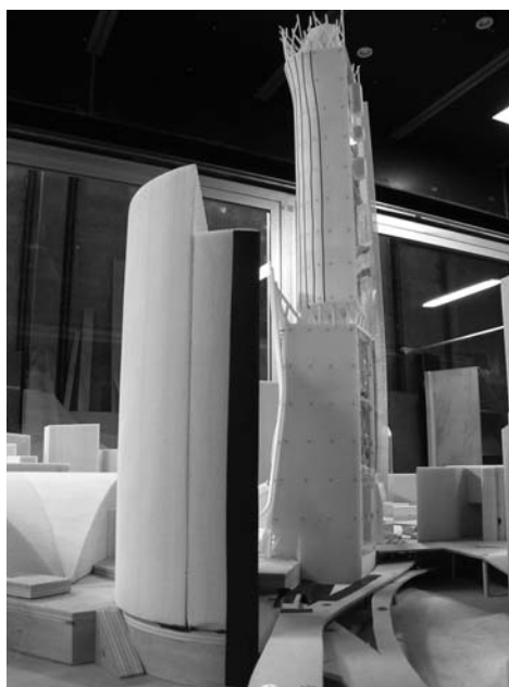
Fig. 10.10. - Similitude du nombre de Reynolds – Maquette de la tour phare (Paris – La Défense) équipée de ses rugosités de surface (bandes noires collées sur la forme arrondie de la maquette)
