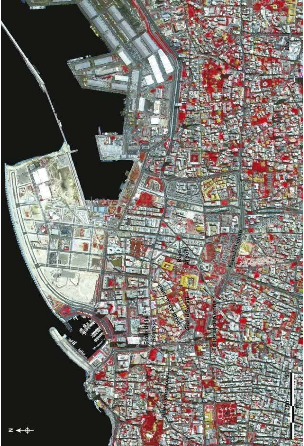
Fusion de deux ortho-images (Pan-sharpening, Projective Resolution Merge) : 1 - Multispectrale (Sentinel 2A MSI, niveau 2A-réflectances BOA, 11-05-2017, bandes 8/4/3), résolution 10 m ; 2 - Panchromatique (Quickbird, 11-04-2017), résolution 0.6 m. Visualisation couleur infrarouge, Hybrid Contrast Stretch – Sources : ESA, DigitalGlobe, Google/Earth
