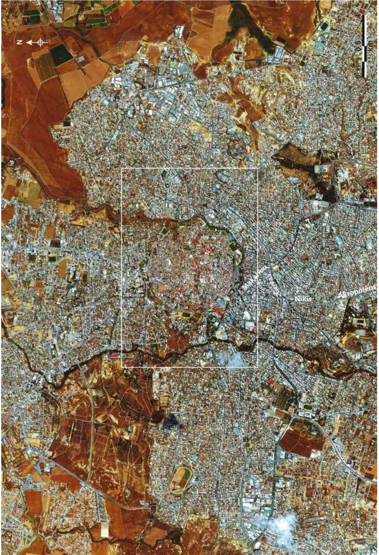
Ortho-image WorldView 2, 10-05-2011, visualisation RGB 5/3/2 – couleurs naturelles, résolution 1,8 m. Amélioration de dynamique HSI, Hybrid Contrast Stretch – Source : ESA, DigitalGlobe
