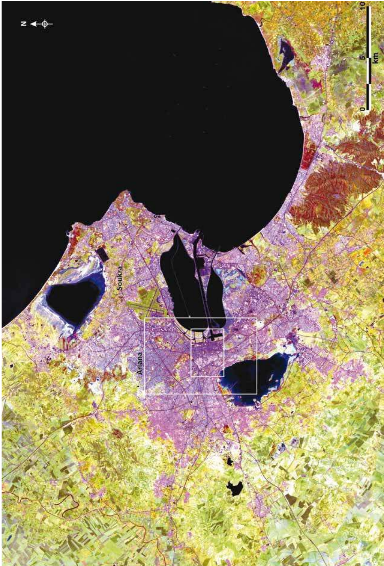
Mosaïque de deux ortho-images Sentinel 2A MSI, niveau 2A-réfléctances BOA, 20-06-2017, visualisation RGBI bandes 12/11/8/3 (SWIR2/SWIR1/NIR/Green), résolution 20 et 10 m. Amélioration de dynamique HSI, Hybrid Contrast Stretch – Source : ESA
