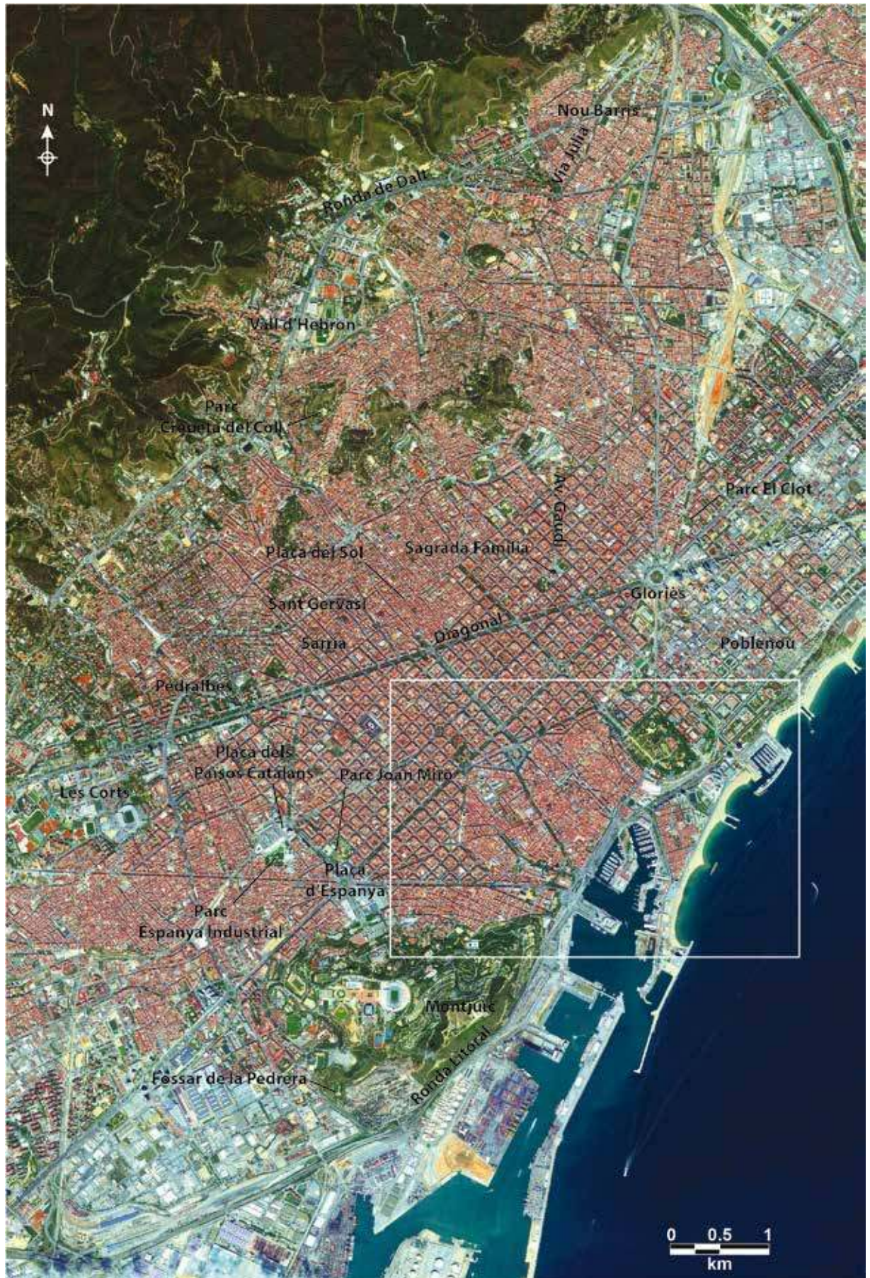
Ortho-image WorldView 2, 26-05-2011, visualisation RGB 5/3/2 -couleurs naturelles, résolution 1,8 m. Amélioration de dynamique HSI, Hybrid Contrast Stretch – Source : ESA, DigitalGlobe
