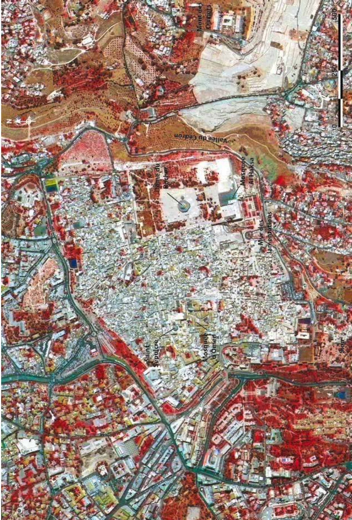
Fusion de deux ortho-images (Pan-sharpening, Projective Resolution Merge) : 1 - Multispectrale (Sentinel 2A MSI, niveau 2A-réflectances BOA, 31-05-2017, bandes 8/4/3), résolution 10 m ; 2-Panchromatique (Quickbird, 23-07-2016), résolution 0,6 m. Visualisation couleur infrarouge, Hybrid Contrast Stretch – Sources : ESA, DigitalGlobe, GoogleEarth
