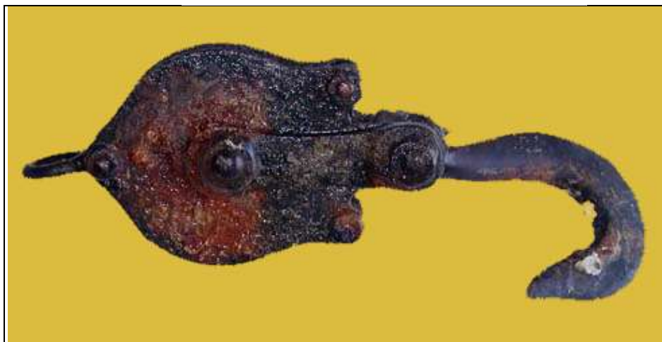
Figure 75 - Poulie simple en bronze (ALS 05 - 15) du palan de pointage d'un canon à pivot (Photo CCAS -15 retouchée)
