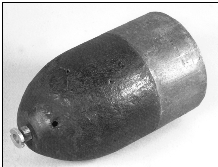
Figure 34 – Obus qui était resté engagé dans le tube du canon Blakely.
