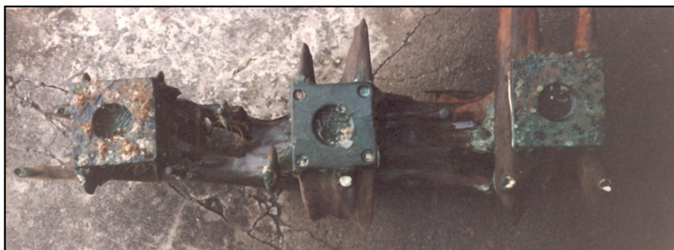
Figure 64 - ALS 150 : trois pivots obturés par un tampon de bois
