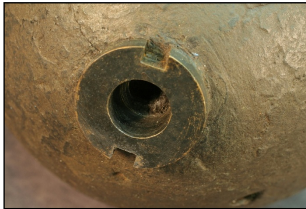
Figure 46 – Fusée vissée sur l'ogive de l'obus mis au jour en 2005
