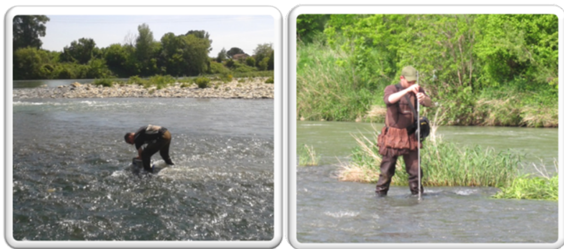
Photo 5.1-5.2 - Photo 5.1, à gauche, échantillonnage au cylindre de Hess (Montélimar, 24/04/2014). Photo 5.2, à droite, mesure de vitesse moyenne (Montélimar, 27/05/2012).
