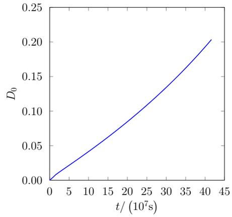
(d) Damage for purely mechanical loading
