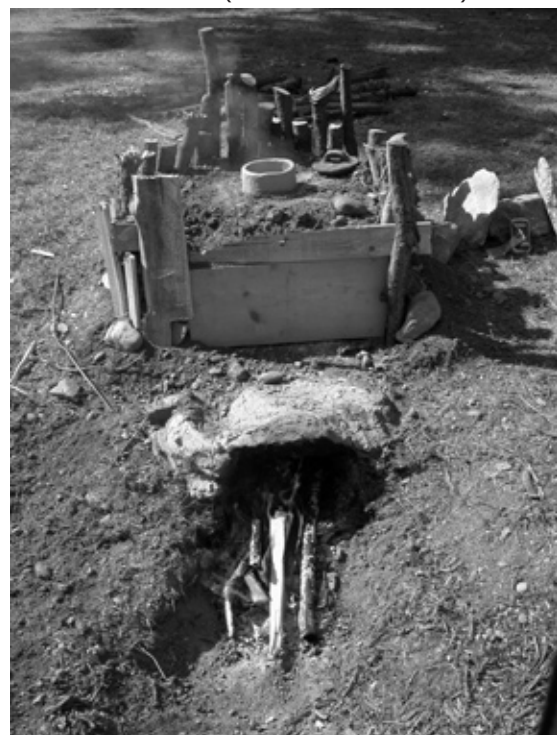
Figure 7 : Mise en place du couvercle après le chargement en tas des céramiques dans la partie basse du four (cliché : X. Deparnay).
