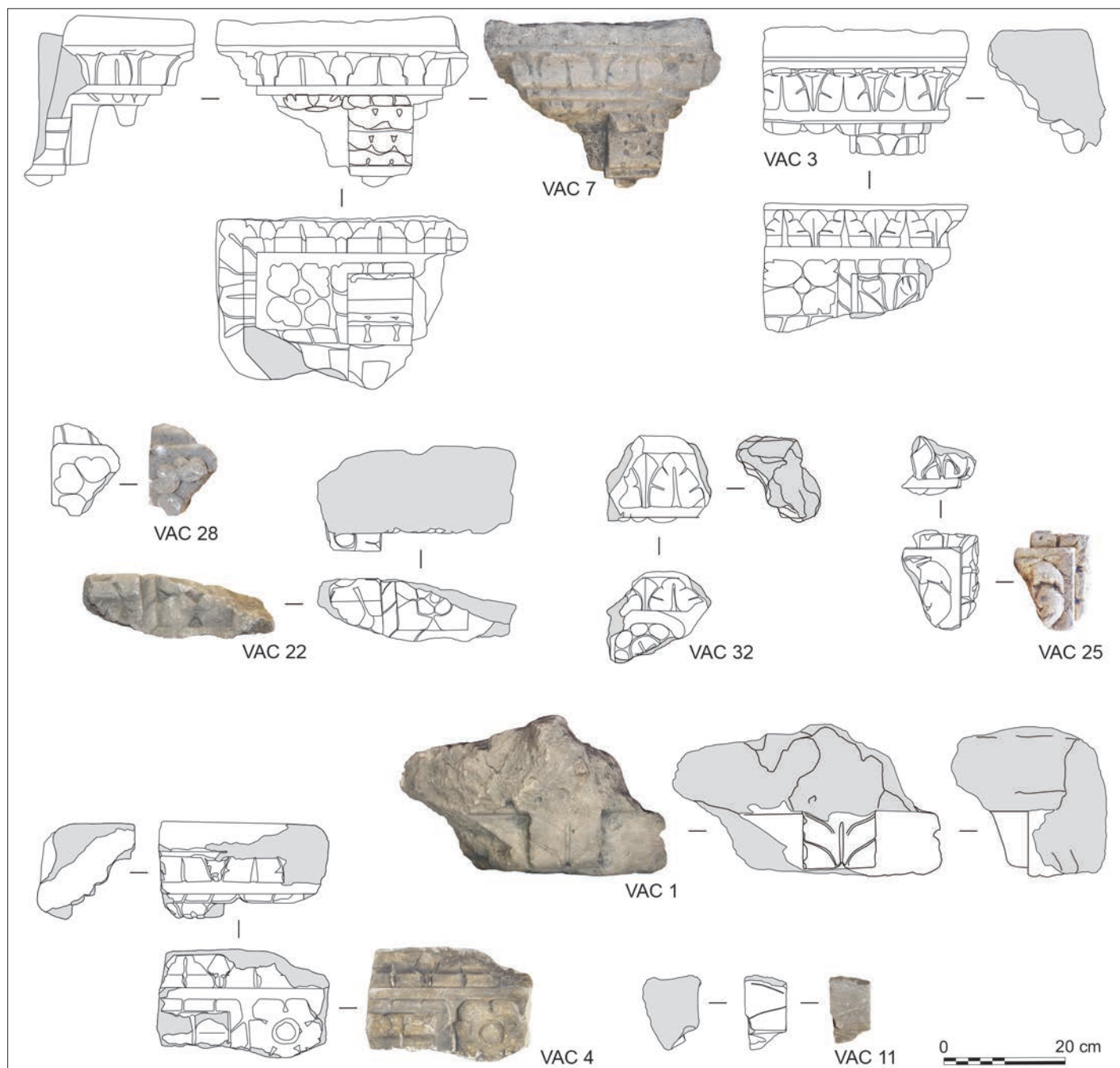
Fig. 10 – La corniche modillonnaire corinthienne et ses variantes décoratives (DAO et clichés : D. Mattiuz).
