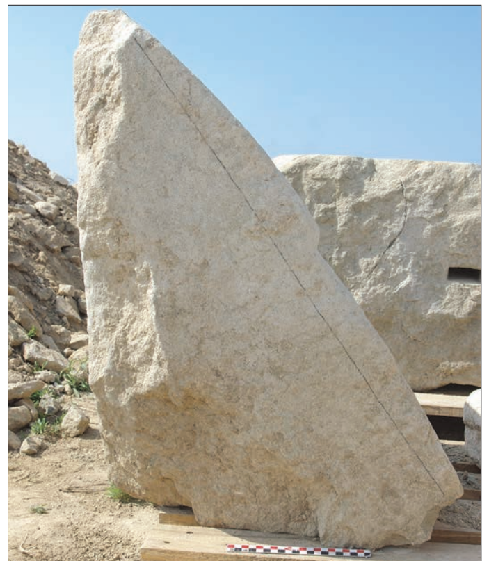
Fig. 13 – Bloc n o XI du mur sud ou nord du mausolée avec un lit d'attente convexe divisé en deux surfaces ; le tracé au crayon matérialise l'hypoténuse d'un triangle rectangle (cliché : R. Pellé).
