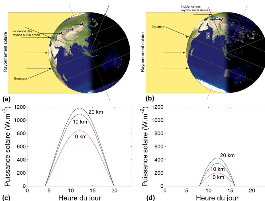
**Figure 8.** Ensoleillement d'un drone HALE solaire (a) au solstice d'été et (b) au solstice d'hiver et puissance solaire surfacique disponible à l'horizontale en fonction de l'altitude, à 48° de latitude (Paris), (c) au solstice d'été et (d) au solstice d'hiver
