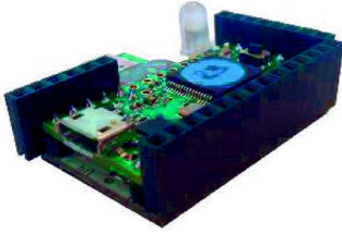
Fig. 13. DecaWiNo: Deca-Wireless Node.
