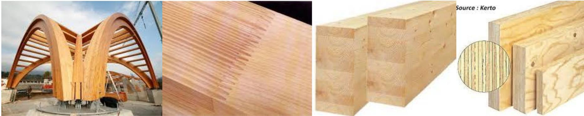
**Panneaux et coques:** obtenir des géométries 2D par collage perpendiculaire de planches (CLT) ou de placages (contreplaqué)
