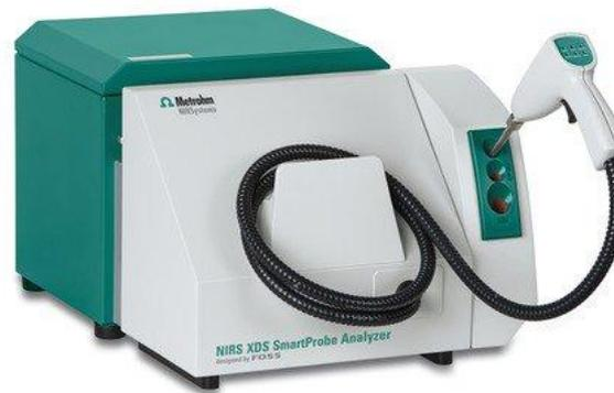
Spectromètre proche infrarouge pour quantifier la richesse en tannins
