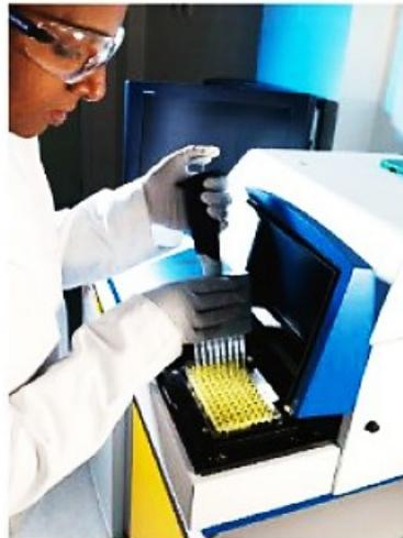
Remplissage des puits à l'aide d'une micropipette
