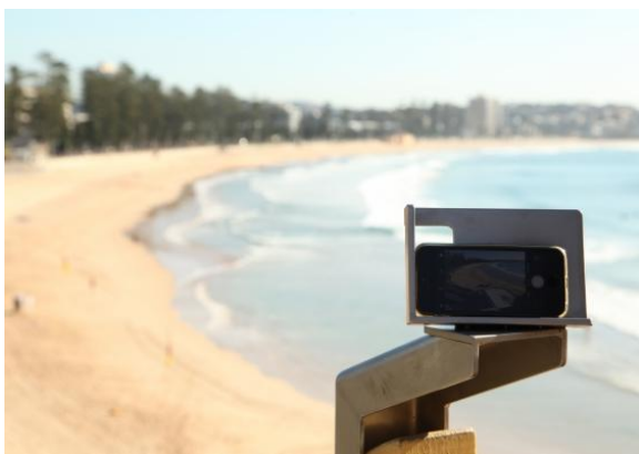
Figure 31 : Dispositif Coastsnap (environment.nsw.gov.au)
