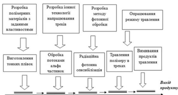
Рис. 6. Технологічний процес розробки технології треків мембран з поліціануратів
