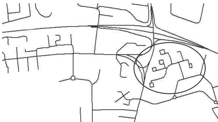
Figure 21. Le groupe d'impasses complexe entouré permet de détecter et caractériser une zone industrielle.
