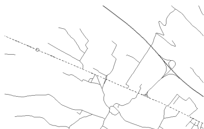
Figure 11. Le stroke sélectionné (en tirets) est important car il dessert beaucoup de routes secondaires par des carrefours en T.
