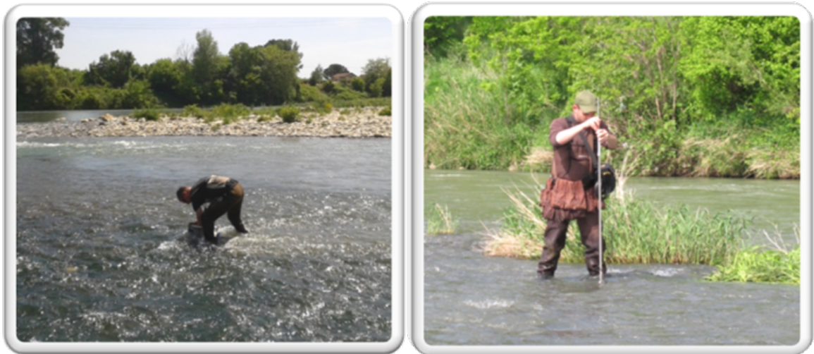
Photo 5.1-5.2 - Photo 5.1, à gauche, échantillonnage au cylindre de Hess (Montélimar, 24/04/2014). Photo 5.2, à droite, mesure de vitesse moyenne (Montélimar, 27/05/2012).
