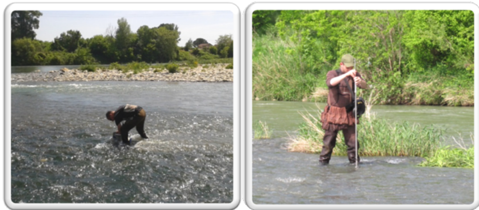
Photo 1-2 - Photo 1, à gauche, échantillonnage au cylindre de Hess (Montélimar, 24/04/2014). Photo 2, à droite, mesure de vitesse moyenne (Montélimar, 27/05/2012).
