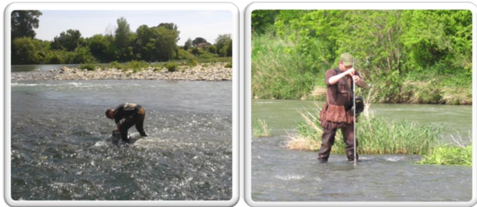
Photo 1-2 - Photo 1, à gauche, échantillonnage au cylindre de Hess (Montélimar, 24/04/2014). Photo 2, à droite, mesure de vitesse moyenne (Montélimar, 27/05/2012).
