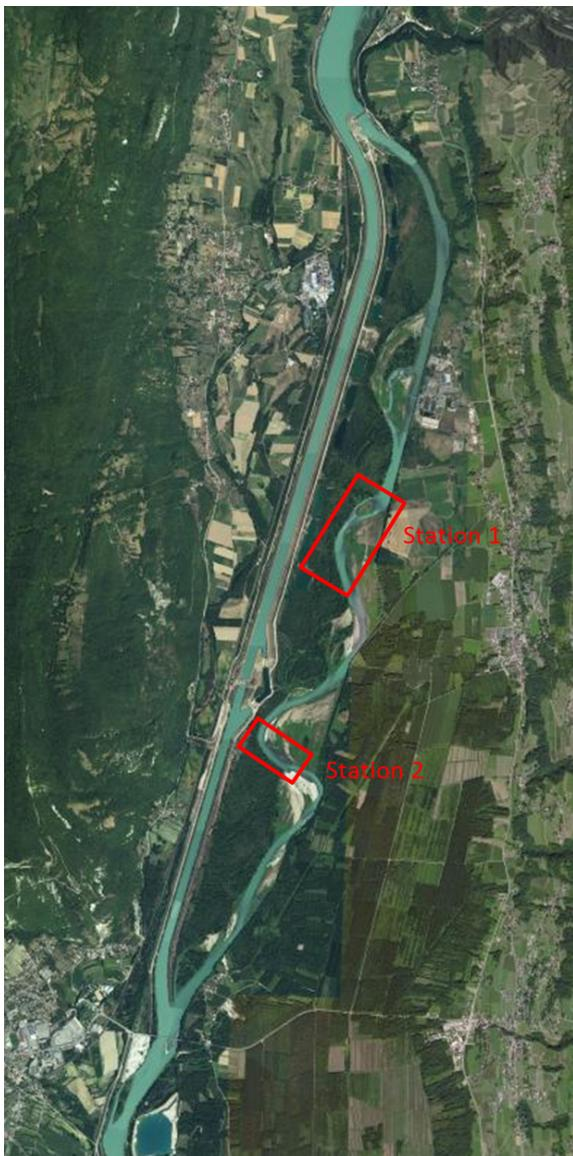
rehaussement de débit réservé. Les contraintes liées à la méthode d'échantillonnage (diamètre du substrat < 30cm et profondeur < 70 cm) nous ont permis de définir 2 zones échantillonnables. Dans ces zones ont été défini deux stations (succession plat/radier, voir photo 3). Les coordonnées de la station d'échantillonnage sur le vieux-Rhône de Chautagne sont :
