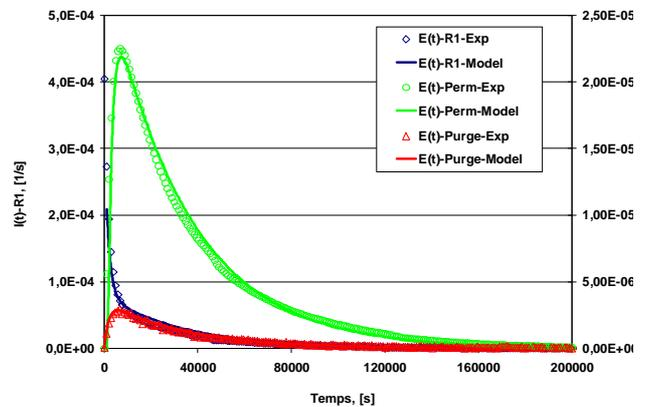
Figure 5. Fonctions de DTS et DAI expérimentales et simulées.
