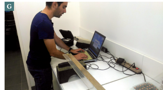
E - Le SCOPIX : radiographie de la carotte. F - Mesure au spectrophotomètre : analyse des couleurs de la carotte. G - Mesure à la sonde Bartington : analyse de la susceptibilité magnétique de la carotte.
