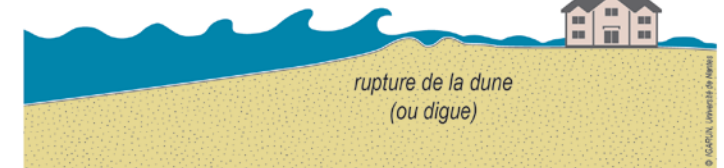
Figure 2 : mécanismes de submersion marine.
