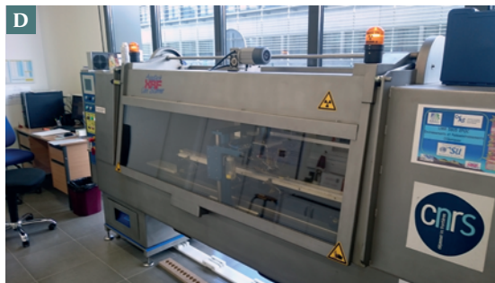
B - L'analyseur SC 832 : analyse des quantités de soufre et de carbone présentes dans chaque échantillon. C - Le granulomètre Malvern : analyse de la taille des grains de chaque échantillon. D - Mesure d'une carotte au sein du XRF : analyse de la composition géochimique de la carotte.
