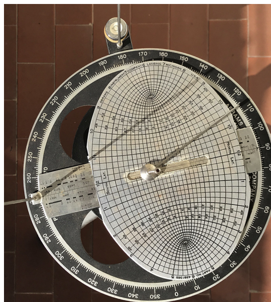
Fig. 7. Compas solaire de type Abrams utilisé pendant la Seconde Guerre mondiale. L'ombre du gnomon permet de déterminer la direction du nord géographique en fonction de la date et de la latitude.
