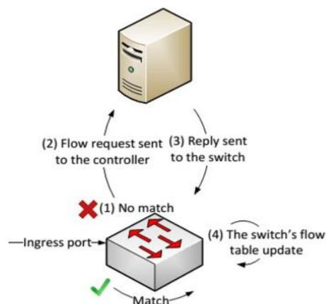
Figure 2 : processus de transmission d'un paquet avec openflow [14]
