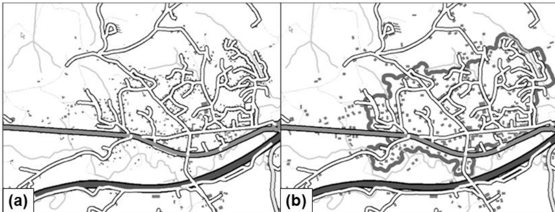
Figure 15 : (a) données initiales symbolisées pour le 1 : 50000. (b) zone urbaine généralisée par AGENT, puis espaces ruraux généralisés par CartACom et les routes par les Beams (la zone urbaine est délimitée).
