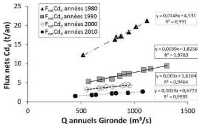
Fig. 8. Diagramme montrant les quatre régressions linéaires servant d'abaques pour l'estimation des flux nets annuels de cadmium dissous ( $Cd_d$ ) exportés par la Gironde pour les quatre dernières décades.
