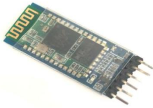
fig 3 : Module Bluetooth HC05 ZS-040
