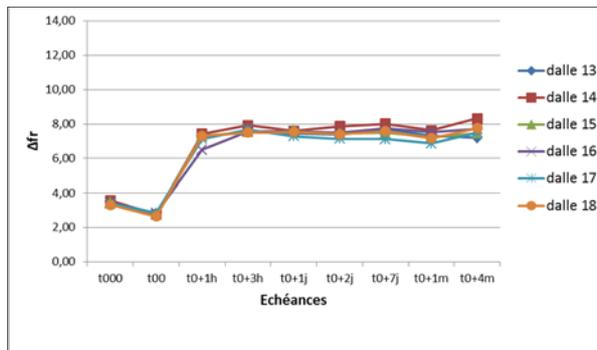
Figure 11 : Progression du front d'imbibition pour les dalles à base de CEM I
