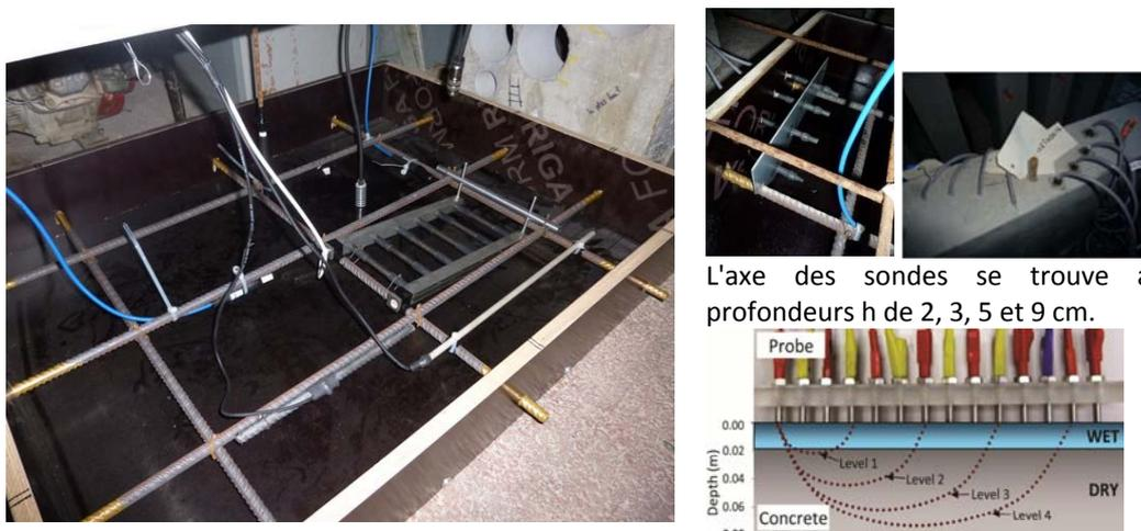
Figure 2 : Instrumentation des dalles avec différents capteurs.
