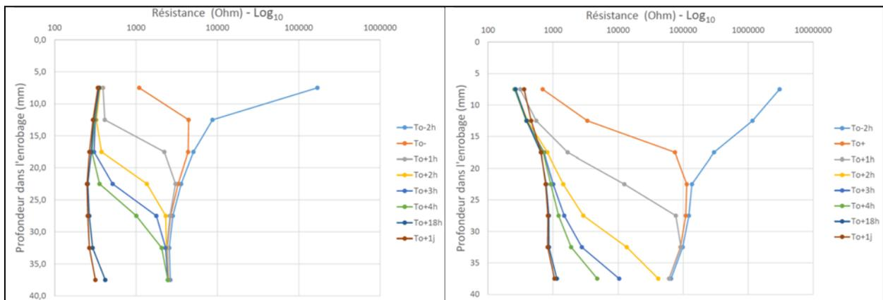
Figure 6 : Profondeurs d'enrobage et résistances en fonction du temps ; à gauche capteur MRE1 (Dalle 19-1-C-M1) et à droite capteur MRE3 (Dalle 09-3-C-M3).
