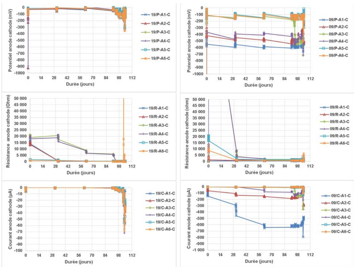
Figure 8 : Potentiels, résistances et courant (entre anode et cathode) en fonction de la profondeur d'enrobage entre T0 et T0+4mois ; à gauche la dalle 19-1-C-M1 et à droite la dalle 09-3-C-M3.
