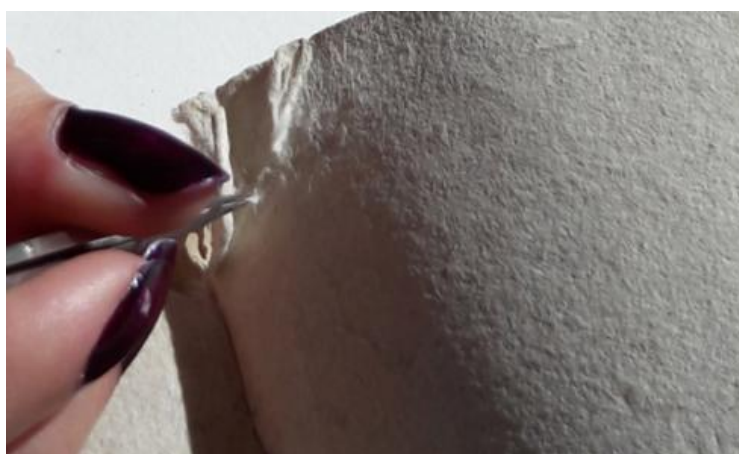
Illustration n° 1 : Prélèvement de fibres de parchemin sur l'un des manuscrits chartrains.
