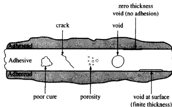
Figure 1 : Défauts dans un assemblage collé [7]
