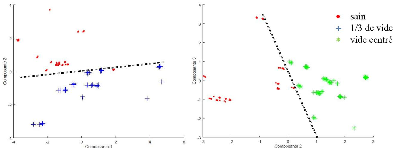
Figure 6 : Répartition des données dans le plan des deux premières composantes pour les échantillons sain ( $N^{\circ}1$ ) et 1/3 de vide ( $N^{\circ}2$ ) « gauche » et pour les échantillons sain ( $N^{\circ}1$ ) et vide centré ( $N^{\circ}3$ ) « droite »
