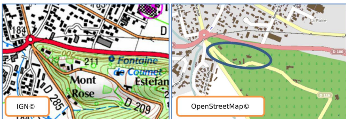
Figure 6 : le niveau de détail de la forêt est incohérent avec les bâtiments dans OSM entraînant une fausse interprétation du lecteur de la carte car les bâtiments ne sont pas dans la forêt mais bien dans une clairière (Touya et Brando, 2013).
