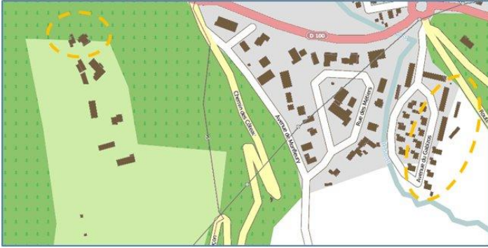
Figure 3 : Exemples d'incohérences de niveau de détail : les bâtiments en haut à gauche intersectent la limite de la forêt et les bâtiments sur la droite sont juste à l'extérieur de la zone bâtie ©OpenStreetMap (Touya et Brando, 2013).
