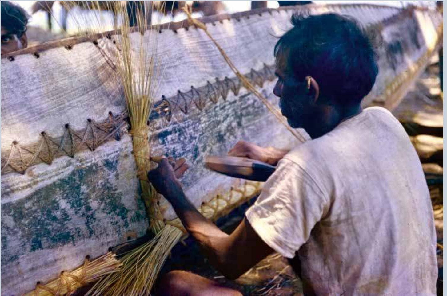
c. Remise en état des padava de Pedda Vâdapêta [grand quartier des Vada] avant la saison Vada et Palli. Pentakota et Puri, Andhra Pradesh, Inde
