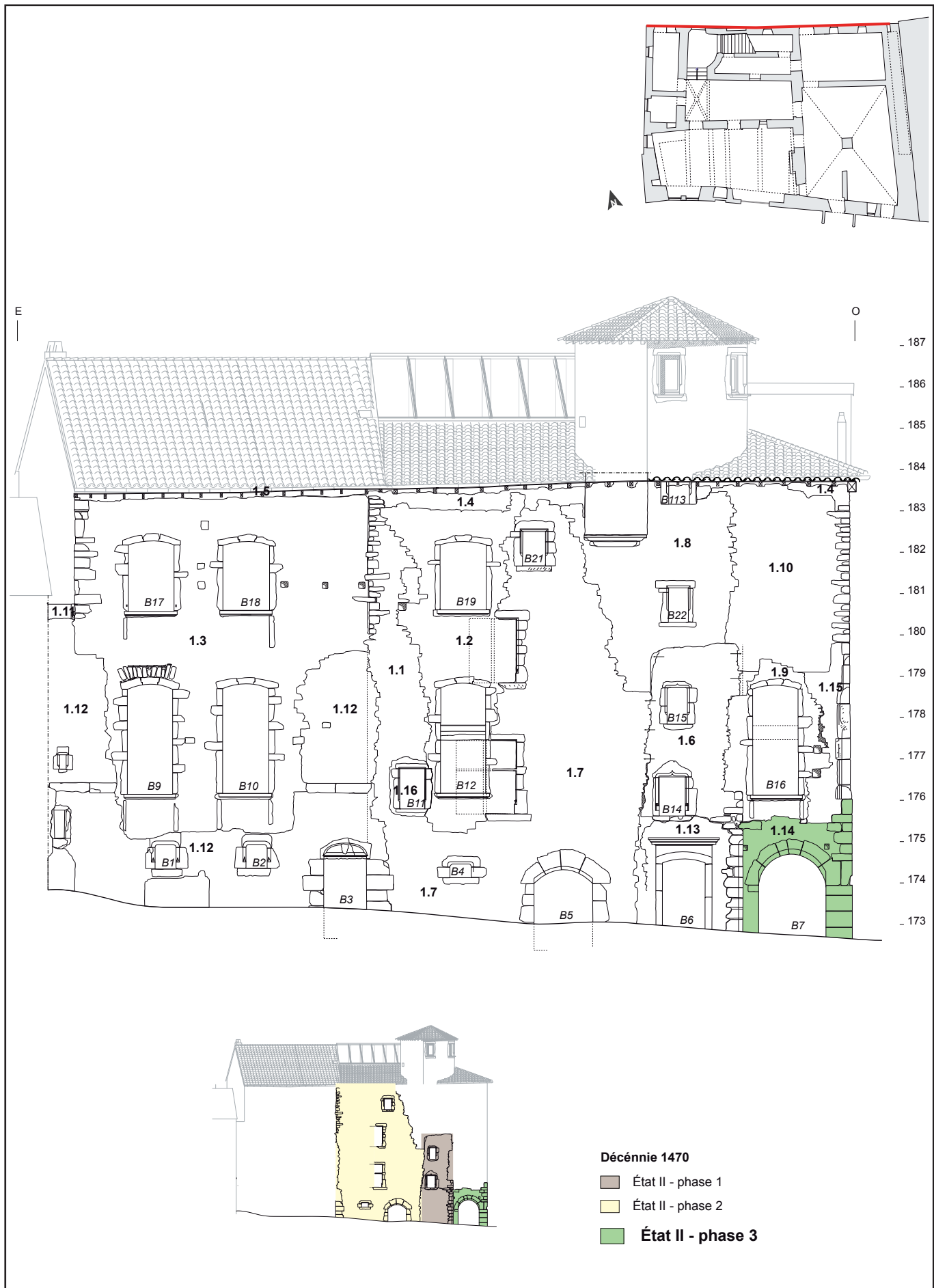
Figure 43 : Mur nord sur rue (UM1), parement nord (UC1.14), état II, phase 3 - (éch. : 1/125).
