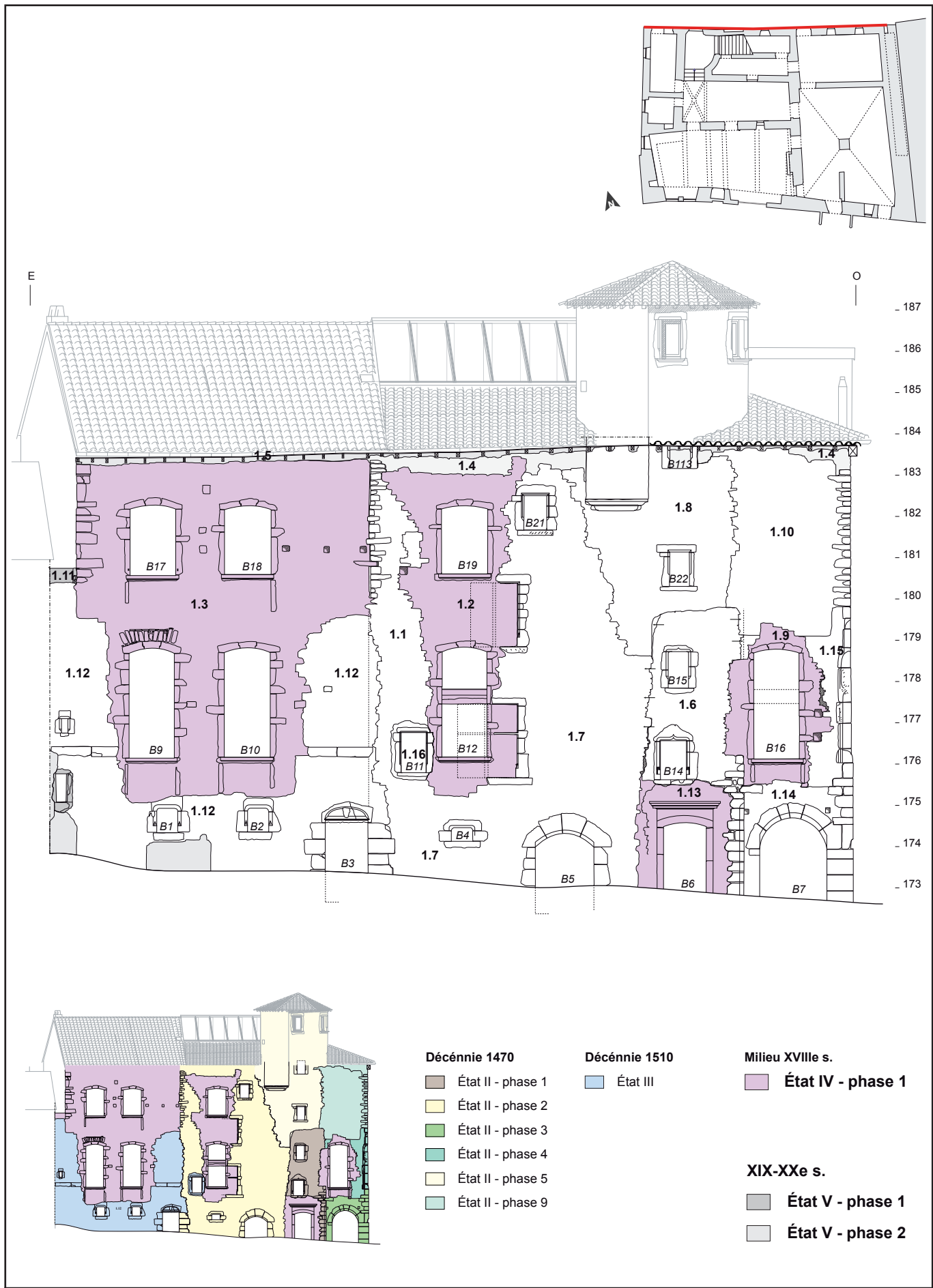
Figure 116 : Mur nord sur rue, parement extérieur nord (UC1.2, 1.3, 1.9, 1.13), état IV - (éch. : 1/125).
