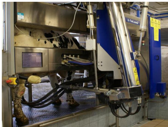
Figure 3 : L'ordinateur de bord du nouveau robot DeLaval VMS V300 (à gauche du bras robotisé) (Source : www.DeLaval.fr )
