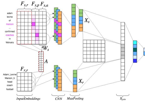
Figure 1 – Architecture siamoise pour la validation de relation
