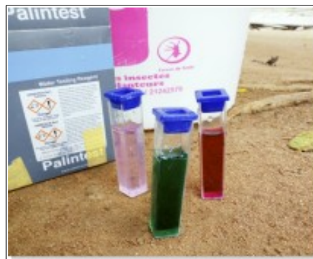
Mesure des concentrations en nitrate et ammoniac in situ
