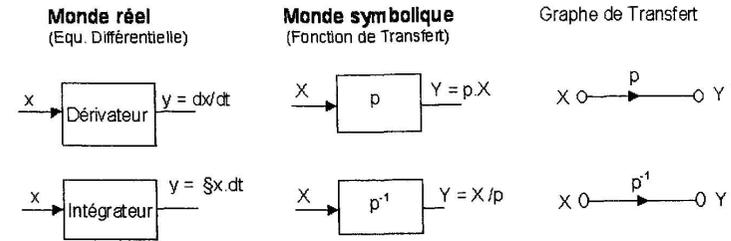
On remarque que dans le monde symbolique pour exprimer la sortie d'un système, il suffit de multiplier l'entrée par la fonction de transfert du système. La fonction de transfert du dérivateur est:  $Y/X = p$  et celle de l'intégrateur est  $Y/X = 1/p$
