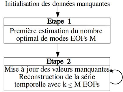
FIGURE 1 – Diagramme la méthode EM-EOF en deux phases. Les données manquantes sont d'abord initialisées. La phase 1 effectue une première estimation du nombre optimal de modes EOF  $M$  qui minimise l'erreur de reconstruction. La phase 2 est un affinage itératif des valeurs manquantes pour reconstruire la série temporelle avec un nombre  $k$  d'EOFs.
