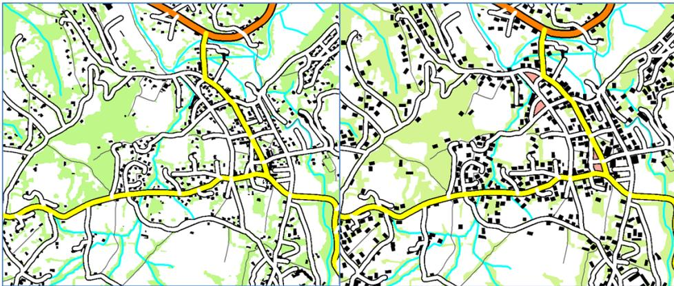
Figure 4 : Carte topographique au 1 : 50 000 non généralisée (à gauche) et généralisée (à droite). Les valeurs de clutter mesurée par densité de contours sont de 429 et 1459.
