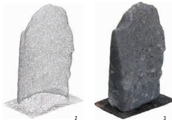
Exemple de levé photogrammétrique sur une statue menhir. 1. Acquisition photographique. 2. Nuage de points. 3. Modèle maillé et texturé.
