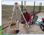
Fig 2. Installation du sismomètre fond de forage (Avril 2013)
