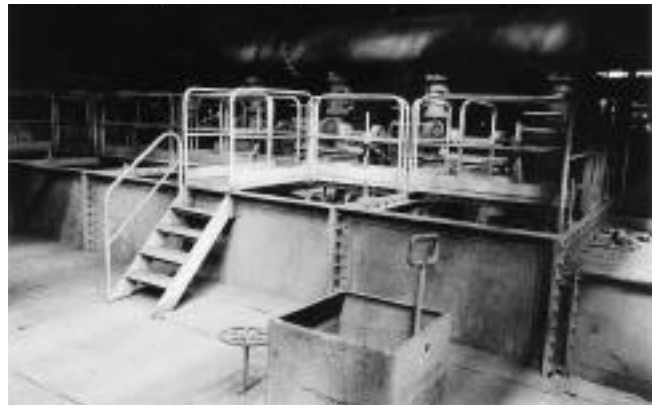
1) Bac à pistonnage pneumatique dit bac P. I. C. (cl. F. Pillet © Ecomusée, 1999 ; Inventaire général, ADAGP, 1999)
