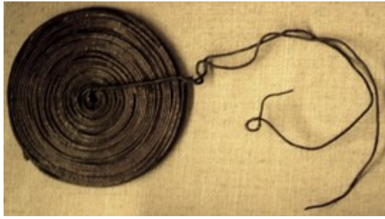
Illustration 2: Spirale d'Ampère (à distinguer du solénoïde "en hélice").
