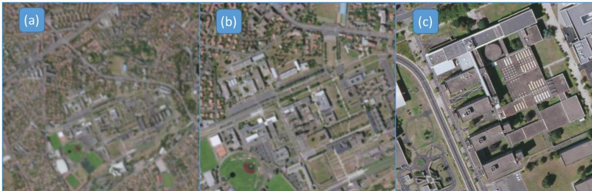
Figure 1. Illustration de l'utilisation du flou sur une orthophotographie servant de support à la saisie : (a) et (b) montrent des échelles peu appropriées à la saisie du bâtiment au centre de (c), et sont légèrement floutées (flou gaussien ici) pour inciter l'utilisateur à zoomer jusqu'à (c).
