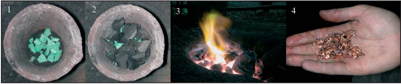
Fig. 2 - Réduction de malachite
