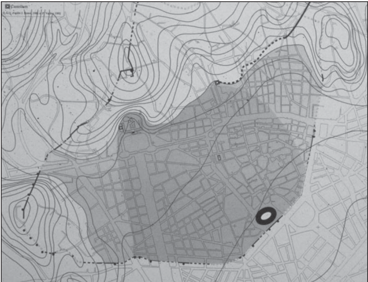
Fig. 8 – Plan de la ville antique de Nîmes sur trame moderne avec en grisé les zones alimentées par l'aqueduc d'Uzès à Nîmes
