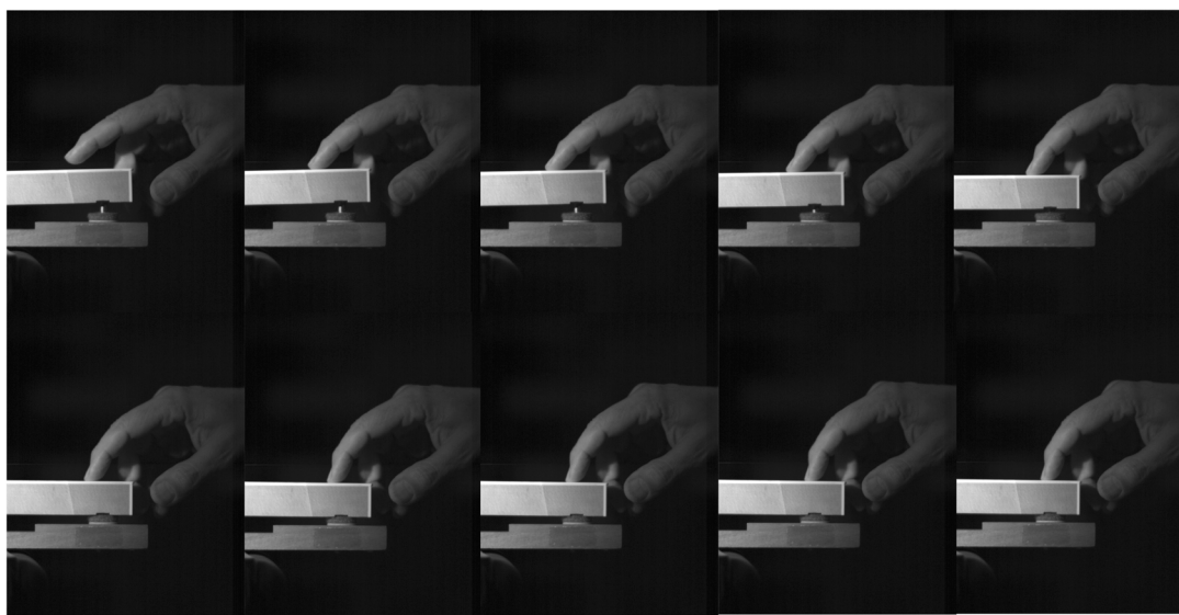
Figure 1 : Attaque de la note avec le toucher tiré , filmé en caméra rapide. Une touche modèle de piano est utilisée pour la visualisation.
